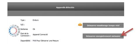
L'enregistrement en mémoire interne de l'appareil ne débute que lorsque la phase de monitorage est active. Avant, la procédure décrite dans le chapitre « <u>Démarrer une mesure</u> » reste applicable.
