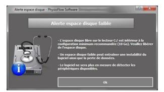
Le logiciel PhysioFlow enregistre toutes les données de l'appareil sur le disque dur local. Pour un fonctionnement optimal, un minimum d'espace disque disponible de 10Go est recommandé. En dessous de cette limite, la fenêtre ci-contre est affichée et demande à l'utilisateur de libérer de l'espace disque.
